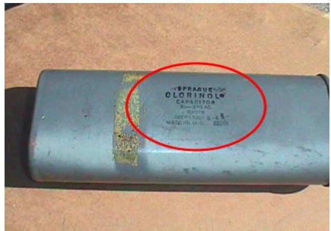
Photo n°4. Condensateur portant la mention « CLORINOL » qui indique la présence d'un fluide contenant des BPC (photo tirée d' internet )
